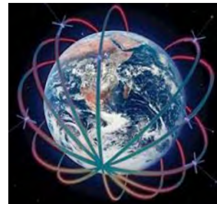
VDES衛星コンステレーション (超小型衛星;約60機。 例:Norsat-2衛星重量20kg)
