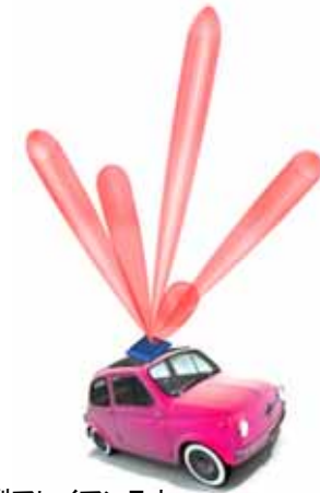
適応型アレイアンテナ ・干渉波を避け、所望衛星を追尾
