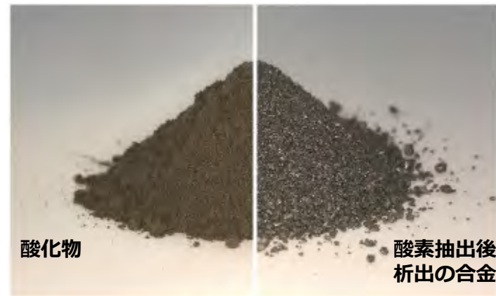
図2 欧州宇宙機関（ESA）は、月土壌を模した酸化物（左）を熔融塩中で電気分解することで酸素を作る実験に成功
