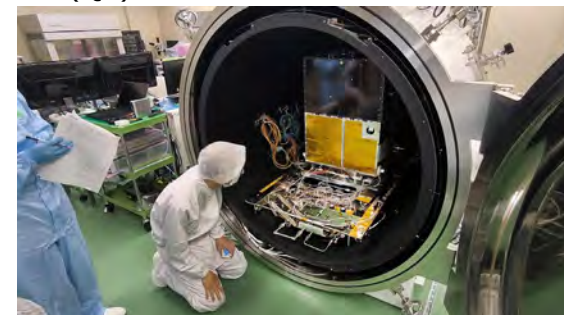
衛星システムEM熱真空試験準備の様子
