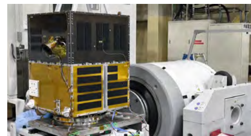
衛星システムEM振動試験 (QT) の様子
