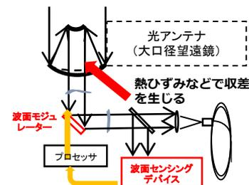
波面センシングデバイスで取差を検出し、その情報から波面モジュレーターを使って取差を補正することで効率よくファイバーに光を入射する
