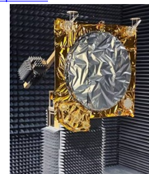
放射性能試験を受けた後に検証されたナビゲーションアンテナ (2023年12月)
