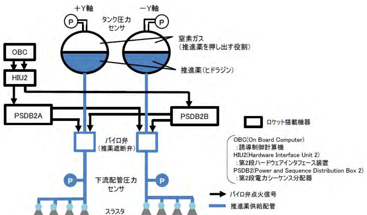
【参考3：推進薬供給配管の閉塞の故障シナリオ】
