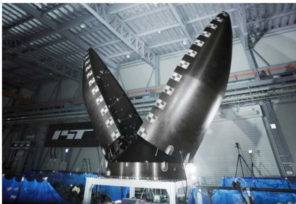
R8. 1. 7 ZERO衛星フェアリング分離放てき試験 (インターステラテクノロジズ)
