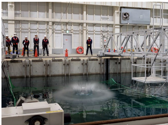
R6. 4. 24 帰還カプセル着水実験 (ElevationSpace)
