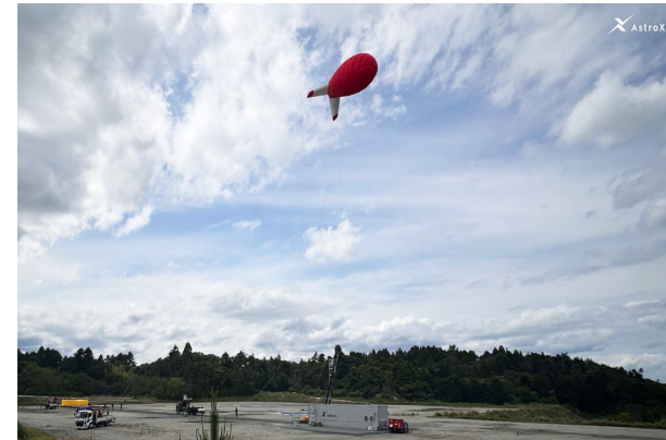
R8. 6. 9 ロケット空中発射に向けた気球係留実験 (AstroX)
