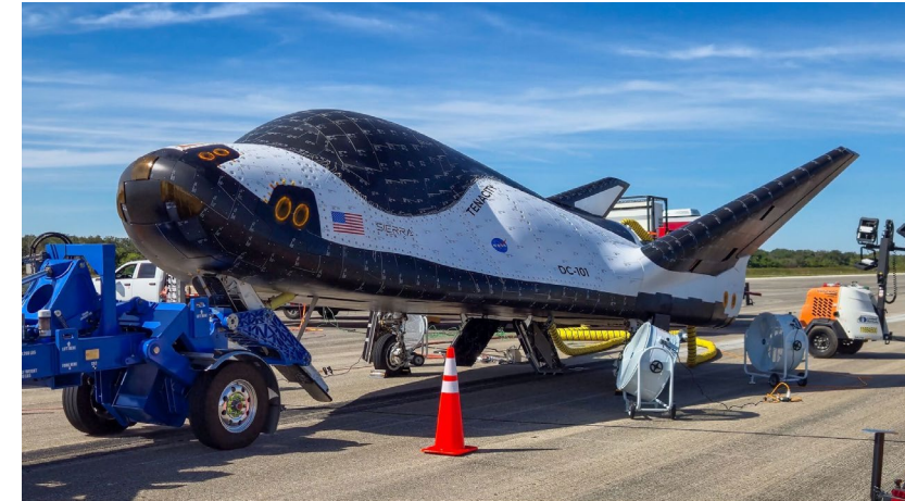
実際の滑走路を用いた走行試験等を行う Dream Chaser (2025年11月頃)
