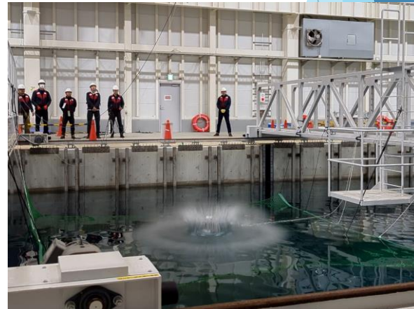
帰還カプセル着水実験 (ElevationSpace)
