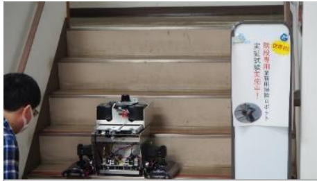
クフウシャ：階段清掃ロボット実証(市役所)
