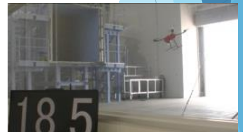
東光鉄工：風洞棟でのドローン耐風試験
