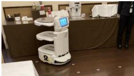
SocialRobotics:配膳ロボット実証(ホテル)
