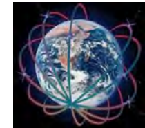
VDES衛星コンステレーション (超小型衛星;約60機。 例:Norsat-2衛星重量20kg)
