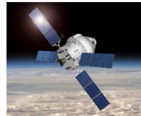
Orionに提供される欧州サービスモジュール (ESM) (出典: ESA)
