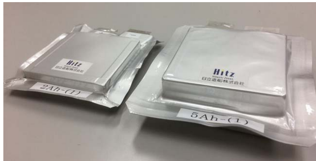
図：試作した2Ah(左)と5Ah(右)パッケージ電池 (積層方法の改良、見直しにより大型化・高容量化を実現)
