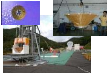
2005~ : 大規模風洞試験@JAXA調布 (Φ1.27m極超音速風洞、6.5m×5.5m低速風洞)
