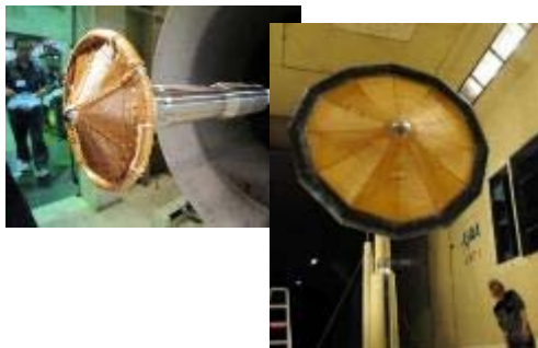
2005~ : 大規模風洞試験@JAXA調布 (Φ1.27m極超音速風洞、6.5m×5.5m低速風洞)
