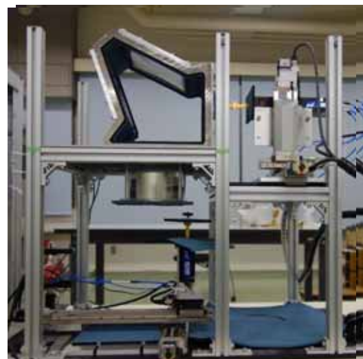
図1 LiteBIRD 低周波望遠鏡 (LFT) 1/4スケールモデルと近傍解アンテナパターン測定システム
