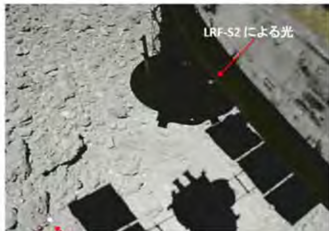
ターゲットマーカー (画像のクレジット: JAXA) 最終降下前: ホバリング中 時刻: 2/22 07: (時刻: 機上、日本時間) 高度: 約8.5m
