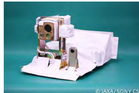
国際宇宙ステーションに設置した小型光通信実験装置
