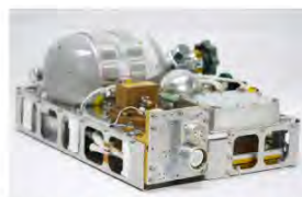
ほどよし衛星搭載の小型イオン推進システム“MIPS” (PROCYON推進系の開発のベースとなった)
