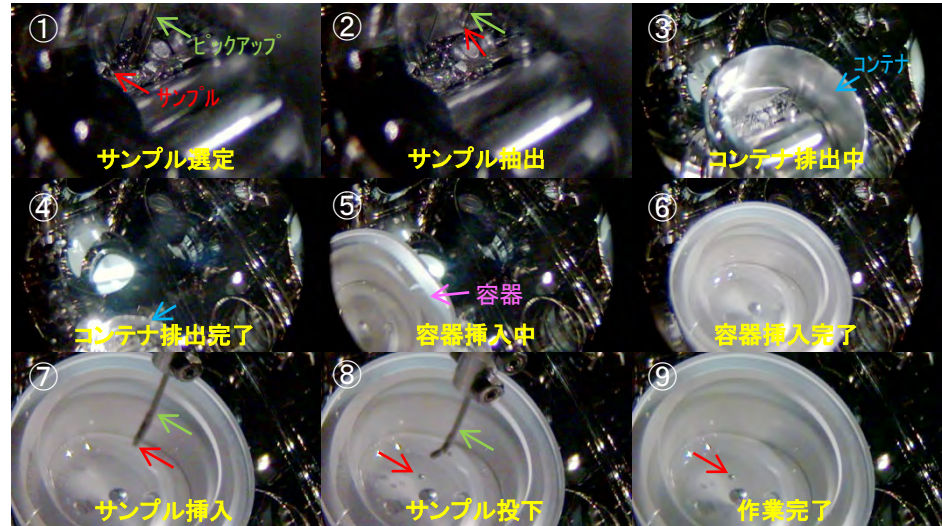
写真2: サンプル収納容器の開封及び試料の一部取り出し作業のリハーサル (模擬試料をカプセルコンテナから容器へ移し替える訓練)
