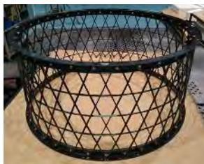
キックステージのCFRP複合材ラティス構造BBM（左写真）
