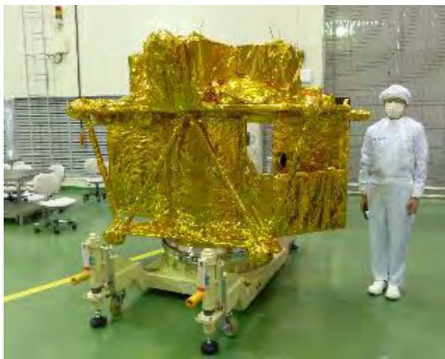
構造試験・熱試験に供せられたSLIM試験モデル
