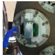
板バネ式圧縮機の冷凍機の性能評価試験用に用いるコールドヘッド部の試作品。ボールベアリングを廃することにより長寿命を実現できる。
