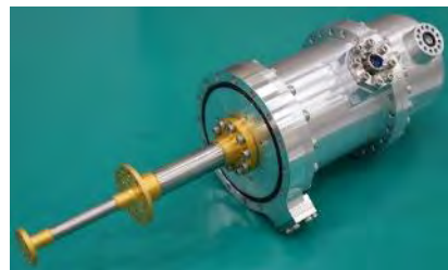
板バネ式圧縮機の冷凍機の性能評価試験用に用いるコールドヘッド部の試作品。ボールベアリングを廃することにより長寿命を実現できる。
