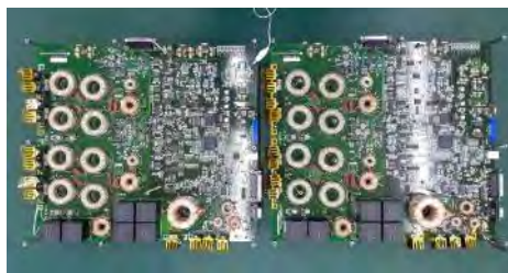
擾乱抑制を目指した駆動回路の試作品。ここで得られる成果は、各種冷凍機に共通的な知見・技術が獲得できる。
