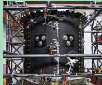
打上時荷重に構造が耐えられるかを確認する静荷重試験
