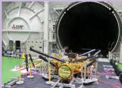
探査モジュール、ミッション機器TTMとスペースチャンバー
