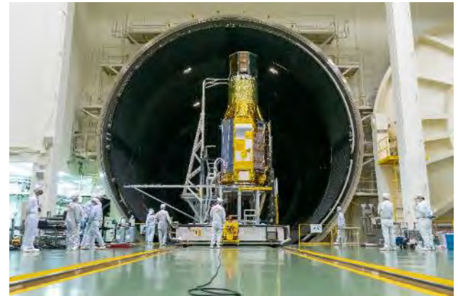
衛星熱真空試験（筑波宇宙センター）
