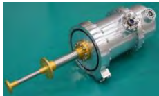
板バネ式圧縮機の冷凍機の性能評価試験用に用いるコールドヘッド部の試作品。ボールベアリングを廃することにより長寿命を実現。
