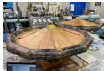
超小型探査機に惑星着陸機能を与える展開型エアロセルの開発
