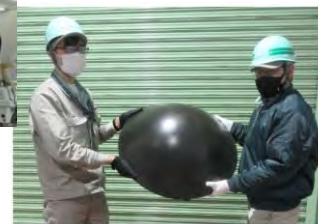
←超小型火星着陸機を実現にむけた、直径2.5mの大気圏突入用展開型エアロシェルを試作した。
