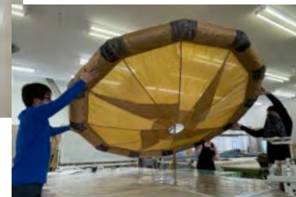
軽量・大型・高耐熱の一体成型アプレータ型をヒートシールド（HS）を実現するための中密度カーボンフェノール系HSの試作品。大型化の足掛かりとして、直径60cmの前面HSを試作→
