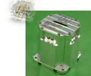
MEMSジャイロを使った国産の小型、軽量、低消費電力のIRUの開発
