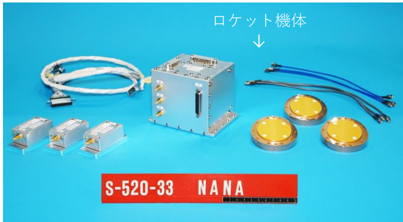
小型ロケット向け航法センサ（NANA）外観
