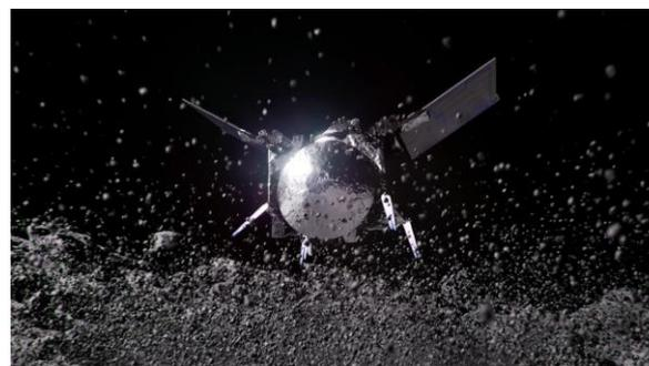
スラスタ噴射によって表面の砂礫を吹き飛ばして表面下を調査する
