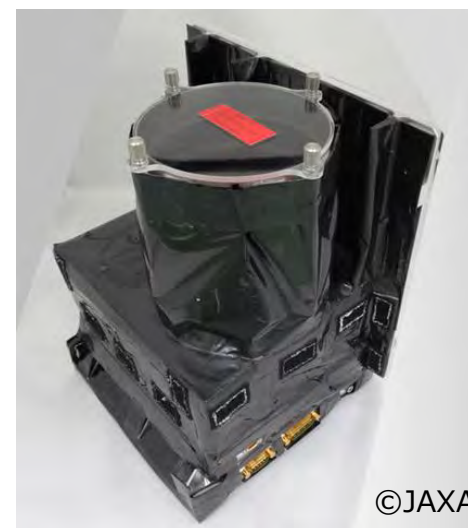
Hera搭載赤外線カメラ (TIRI外観)
