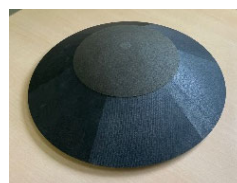
先進的サンプルリターンカプセル技術(ヒートシールド材料の加熱試験(左)と試作品(右))
