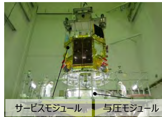
1号機与圧モジュール/ サービスモジュール結合
