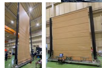
SAP展開収納機構のフルスケールモデル試作試験
