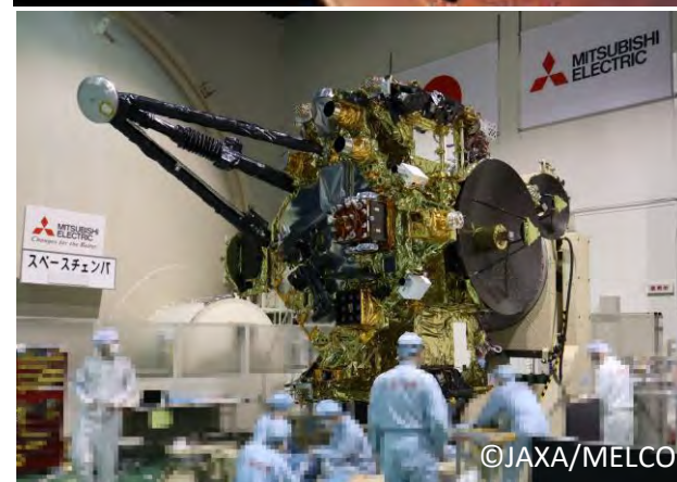
三菱電機 鎌倉製作所における探査機試験風景 (熱真空試験前の探査・復路モジュール)
