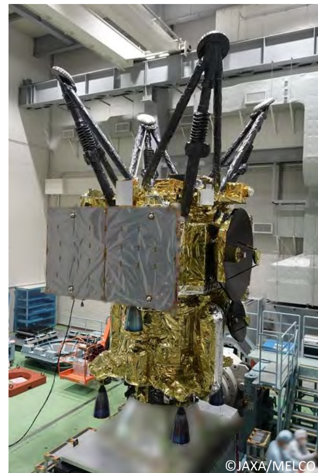
三菱電機 鎌倉製作所における探査機試験風景 (正弦波振動試験の前の全モジュール結合状態)
