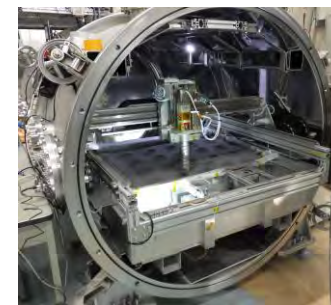
真空環境 掘削採取試験
