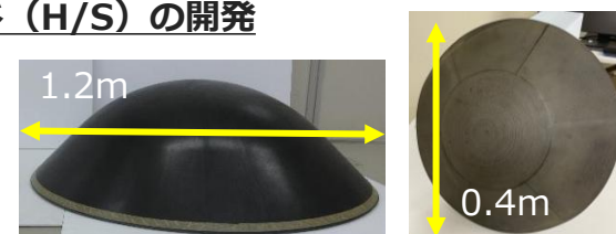
(左) カーボンフェノール系アブレータの直径1.2mのH/Sの試作品、 (右) カーボンポリイミド系アブレータの直径0.4mのH/Sの試作品
