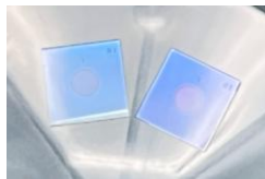
位相マスクの例(1辺は8ミリメートル。 これは旧型で、今年度に開発中の試作品は未完成)
