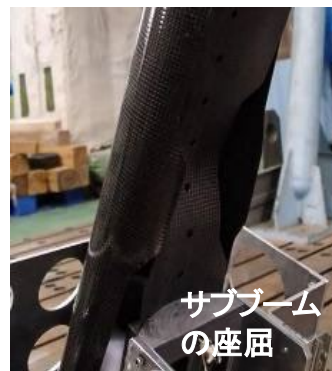
20度傾斜(座屈したケース)
