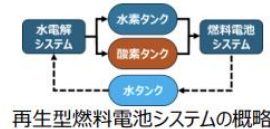
再生型燃料電池システムの概略
