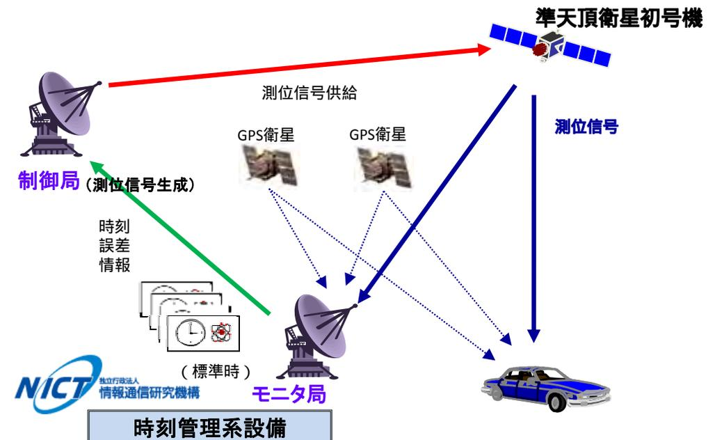
準天頂衛星システムは、我が国の天頂方向に衛星が見えるような準天頂衛星軌道に衛星を配置することで、ビル陰等の影響を受けない高度な衛星測位サービスの提供を可能とするものです。
