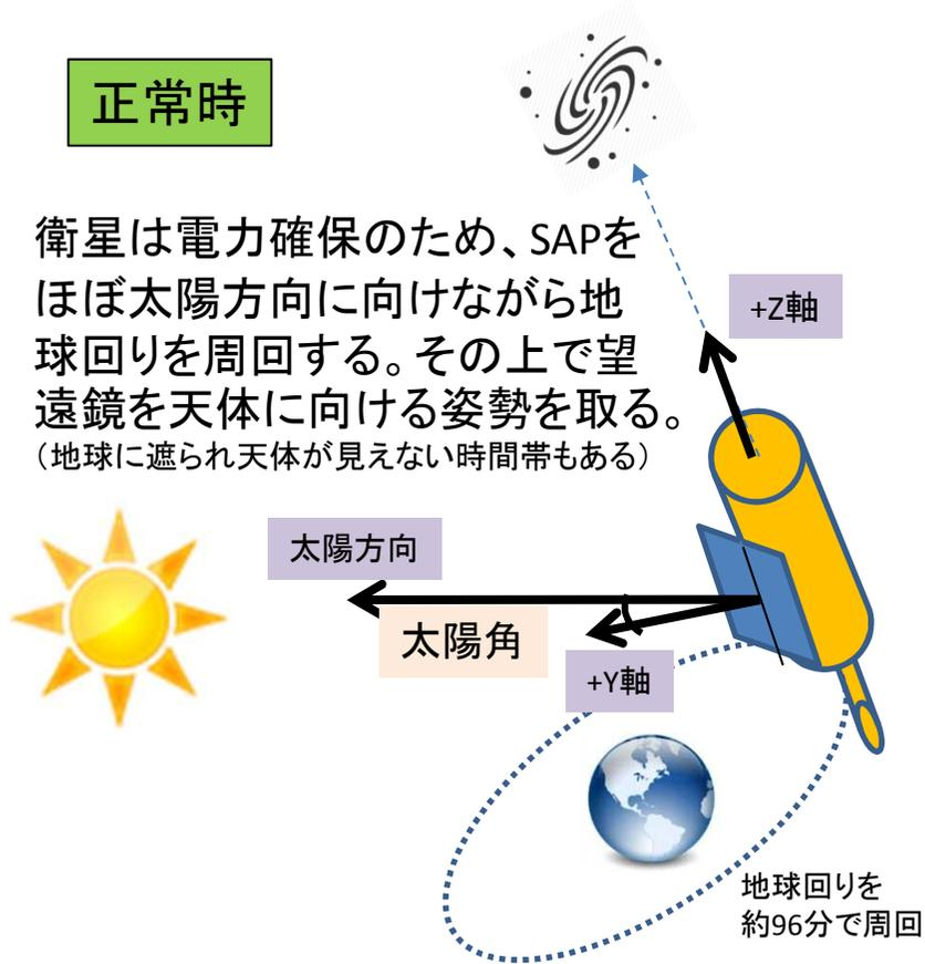
衛星+Y軸と太陽方向のなす角度(太陽角)が、プラスマイナス30度以内であれば正常
