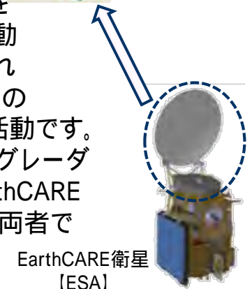
雲プロファイリングレーダ(CPR) [JAXA/NICT]
