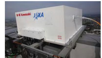
レーザービーム方向制御装置
