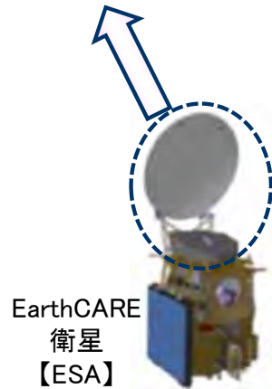
雲プロファイリングレーダ(CPR) 【JAXA/NICT】
