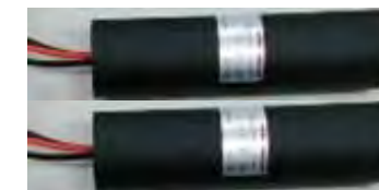
陽電子消滅法の プローブ(長さ120mm)
