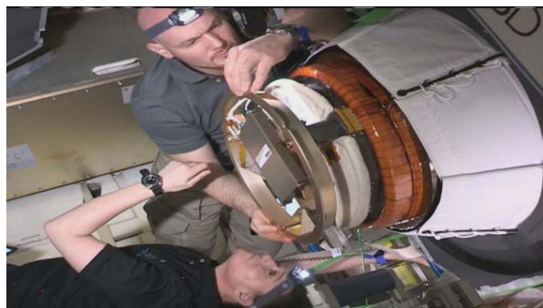
ISS内でクルーによりHTV7に取り付けられるHTV搭載小型回収カプセル（直径84cm）
