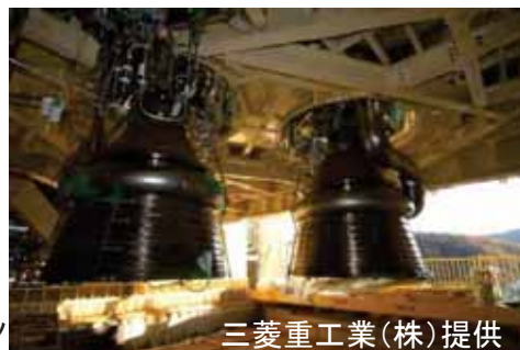
燃焼試験スタンドに 装着したLE-9エンジン
