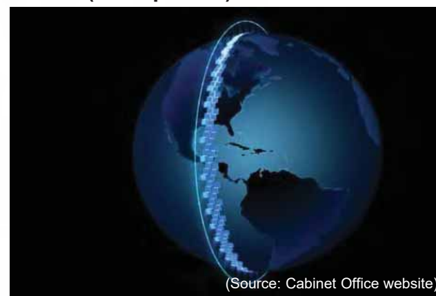
100Kg級超小型衛星50機による地上分解能2.5mの地球観測網構築構想。2018年打上げ開始、2022年に完成予定。
