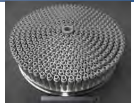
3D造形製造法の一例 (LE-9噴射器エレメント)
