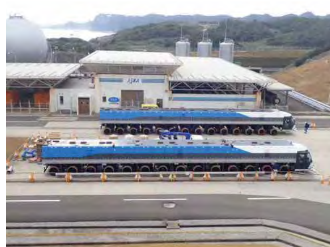
ドーリ(組立完了)
