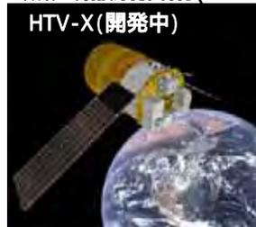
「こうのとり」(HTV)で、有人施設であるISSへランデブーし、物資補給をする技術を確立(2009年-7機連続成功中)。この技術を引継ぎ、更に輸送効率(搭載効率等)を向上させたHTV-Xを開発中。
