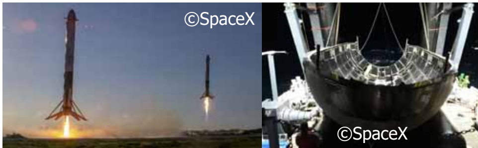
図1: Falcon Heavy2号機のブースタ着陸とフェアリング回収の様子
