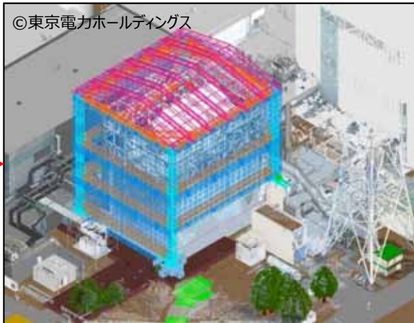
3次元の点群データをポリゴンデータに変換し設計データと合成した画像
