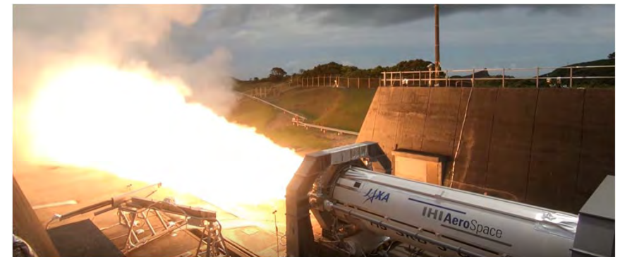
SRB-3地上燃焼試験(2019年8月)
