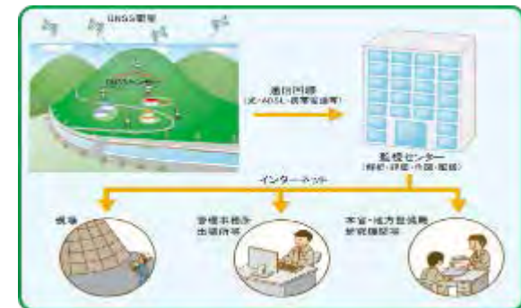
地盤や構造物の変位を計測するGNSSセンサー(第2回国土交通大臣賞、山口大学)
